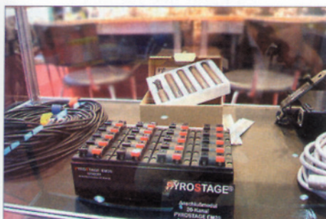
Flexibel: PyroDigit von Pyro-Art ist ein modulares, time-code-fähiges digitales System, das über 1 000 000 elektrische Zünder steuern kann. Im Hintergrund: speziell verpacktes Pyro-Material, das auch in Verkehrsflugzeugen transportiert werden darf. © RN
